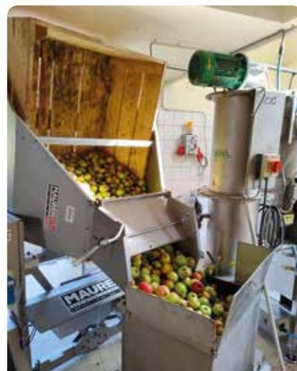
A la vue des normes sanitaires et de l'âge avancé de nos bénévoles, nous avons décidé d'investir dans une nouvelle machine : un basculeur de palette-palox. Ceci nous évite de porter vers le broyeur des sacs de 10 à 50 kg que nous déposaient les particuliers le
